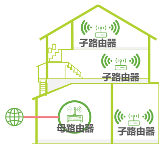
无线Mesh组网 (无需布线)
